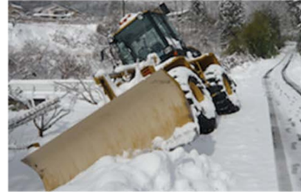
除雪車の転倒
